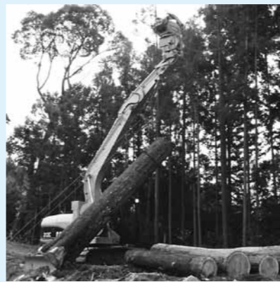
▲スイングヤーダ(集材機) 伐採木を林内に集めます。
