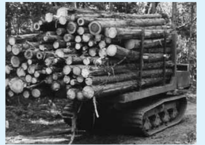
▲フォワーダ(運搬機) 木材を運搬します。
