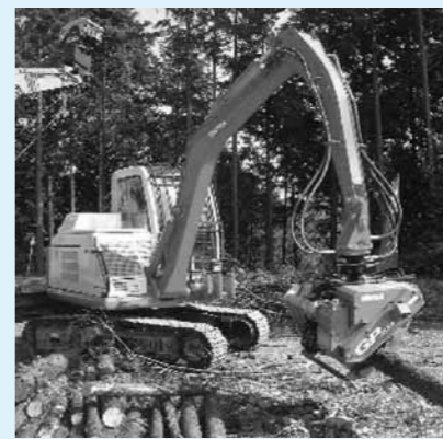
▲プロセッサ(造材機) 伐採木の枝払い・玉切りを行います。
