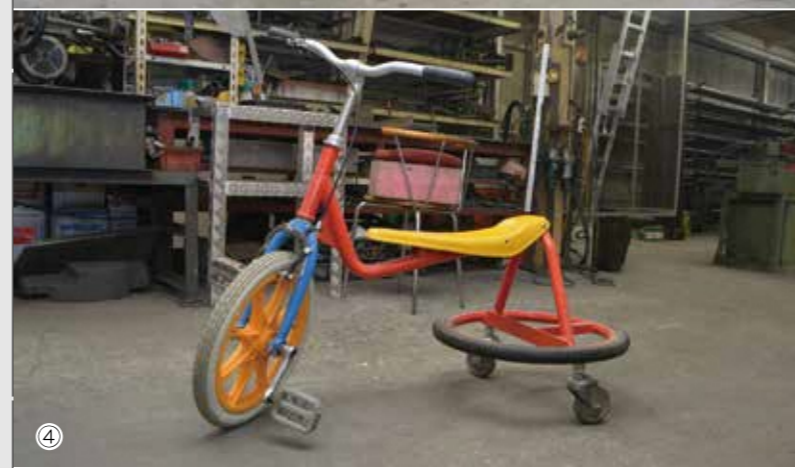
設計・開発製造をした自転車に乗り安全性を自ら確かめる高田さん(写真①)、左右交互に重心を変えることで前へ進む自転車(写真②)、自転車の塗装は息子さんも携わる(写真③)、後輪がドリフト(回転)する自転車。前輪のコントロールで動く(写真④)、現在高田さんが力を入れている水陸両用自転車(写真⑤)。
