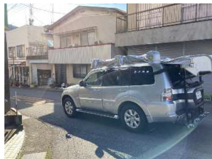
図 2-1 路面性状測定車の例
