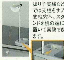
振り子実験などでは支柱をサブ支柱穴へ。スタンドを机の端に置いて実験できます。
